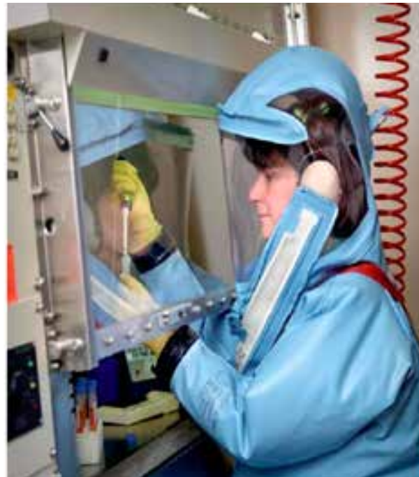
รูปที่ 6 Biosafety Level IV-BSL IV ตู้กระจกสำหรับปฏิบัติงานในห้องชีวนิรภัยระดับ 5
